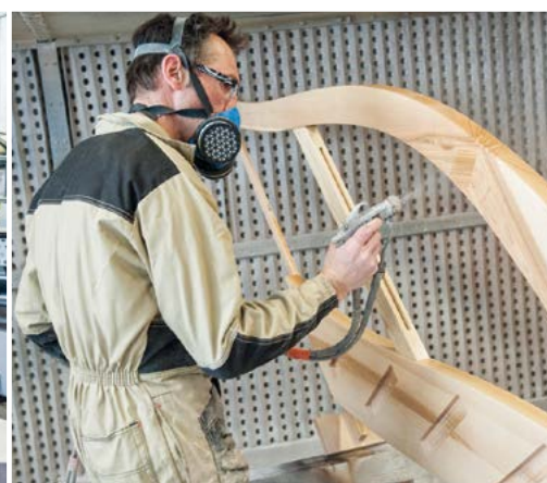
> Poste "Finition". 90% des escaliers sont finis en usine
