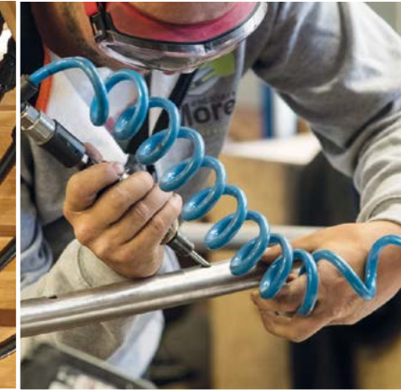
> Poste "Serrurerie". Préparation et finition des poteaux en inox brossé
