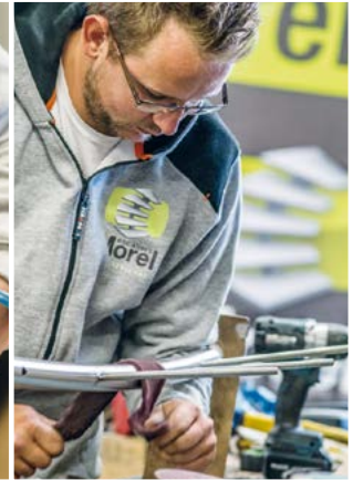
> Poste "Serrurerie". Préparation et finition des poteaux en inox brossé
