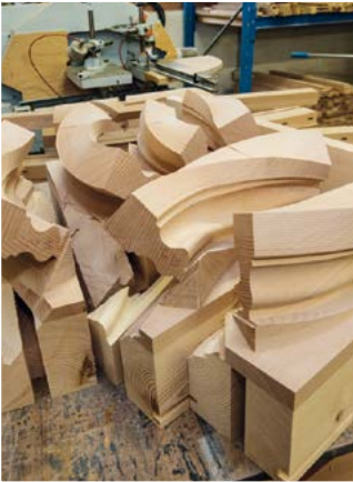
> Mains courantes "débillardées" usinées avec notre CN 5 axes
